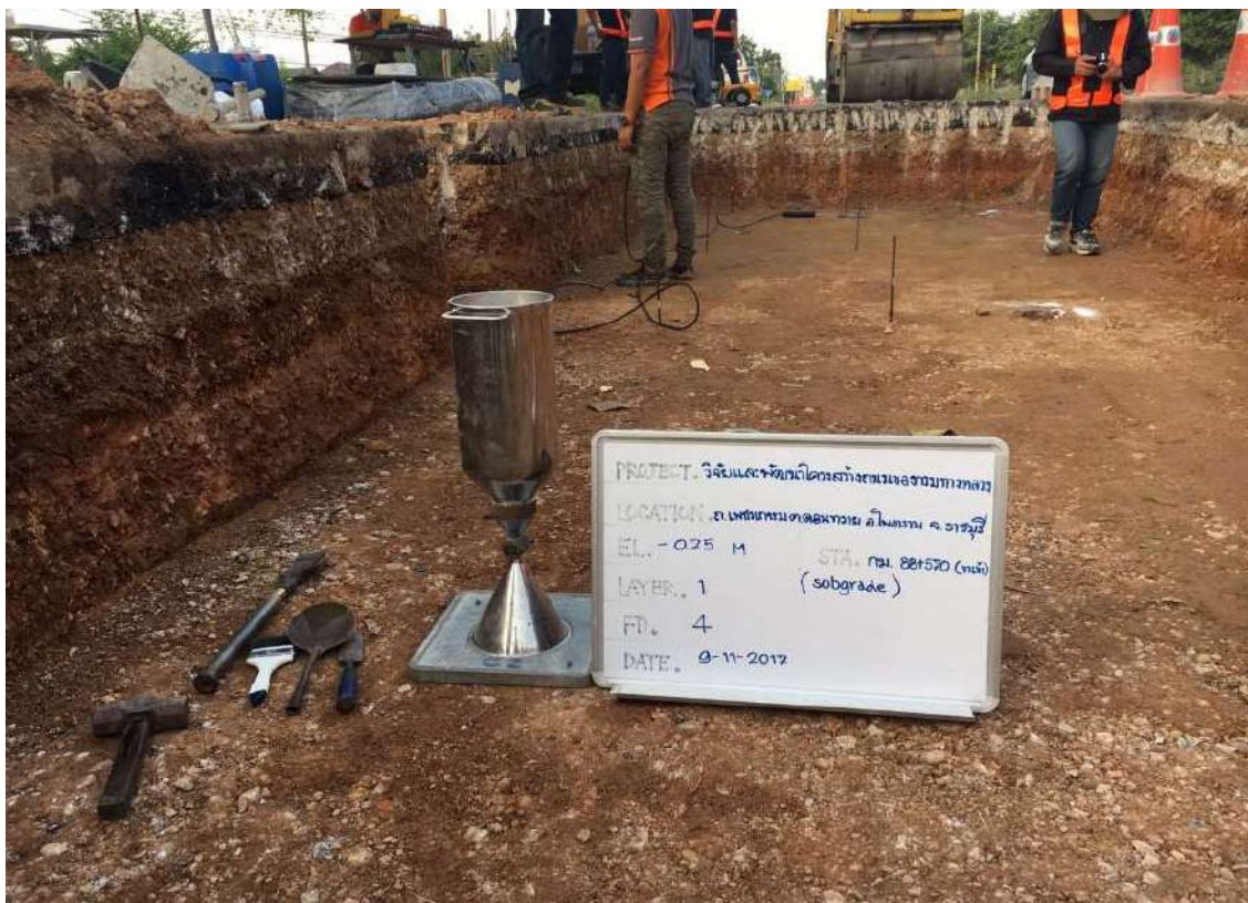
รูปที่ 5.75 การทดสอบความแน่นของวัสดุในสนามโดยใช้ทราย (Field Density Test) ในชั้น Subgrade
