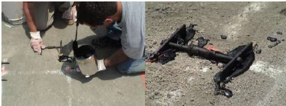
รูปที่ 3.9 ตัวอย่างการติดตั้ง Asphalt Strain Gauge (ที่มา : Timm et al., 2004)
