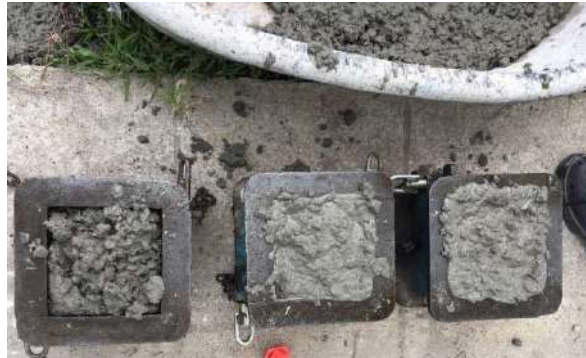
รูปที่ 5.45 การเก็บตัวอย่างคอนกรีตเพื่อทดสอบกำลังรับแรงอัด
