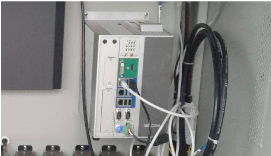
รูปที่ 5.112 หน่วยประมวลผลภาคสนาม (Data Processing Unit) แปลงตรวจวัดโครงสร้างถนนลาดยาง
