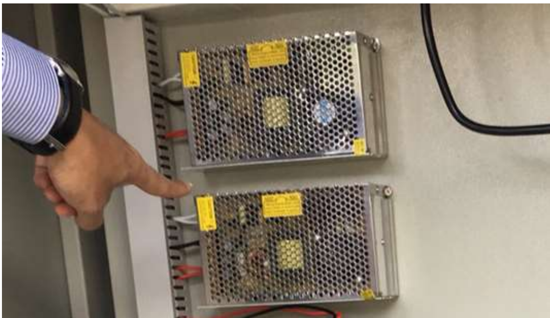
รูปที่ 5.107 อุปกรณ์แปลงไฟฟ้ากระแสสลับเป็นไฟฟ้ากระแสตรงแปลงตรวจวัดโครงสร้างถนนลาดยาง
