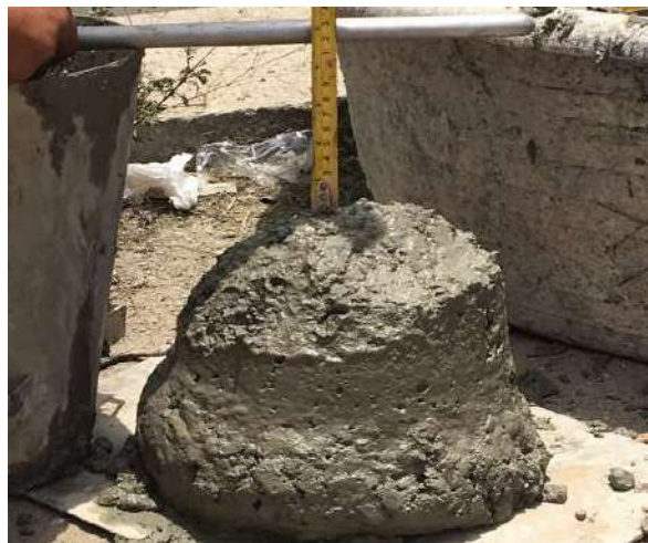
รูปที่ 5.46 การทดสอบค่าการยุบตัว (Slump) ของคอนกรีต
