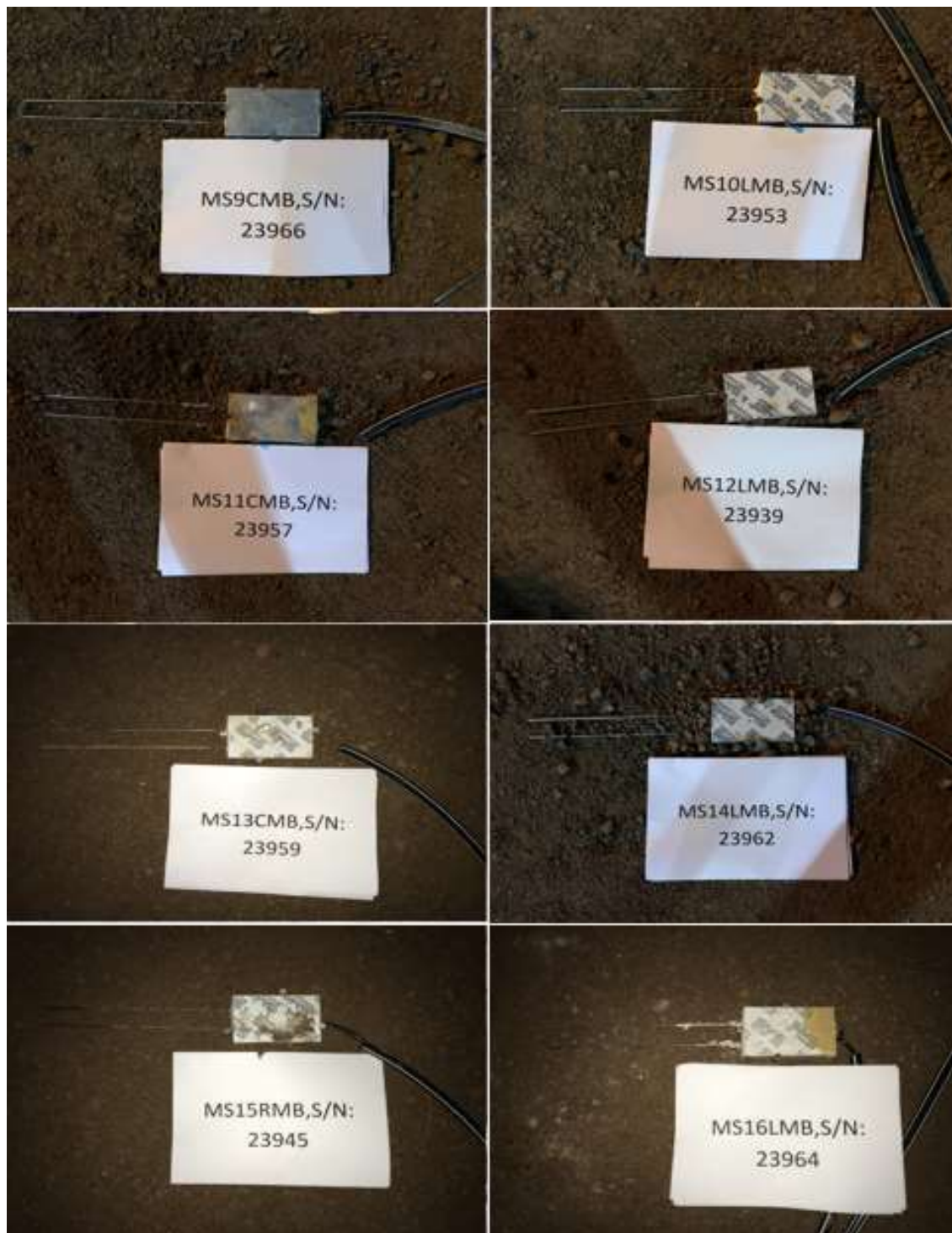
รูปที่ 5.89 งานติดตั้งอุปกรณ์ตรวจวัดความชื้น (Moisture Sensor) ในชั้น Middlebase
